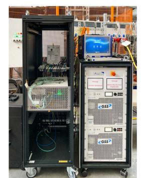
Prototyp eines netzbildenden Stromrichters (links) und steuerbare DC-Versorgung (rechts)
