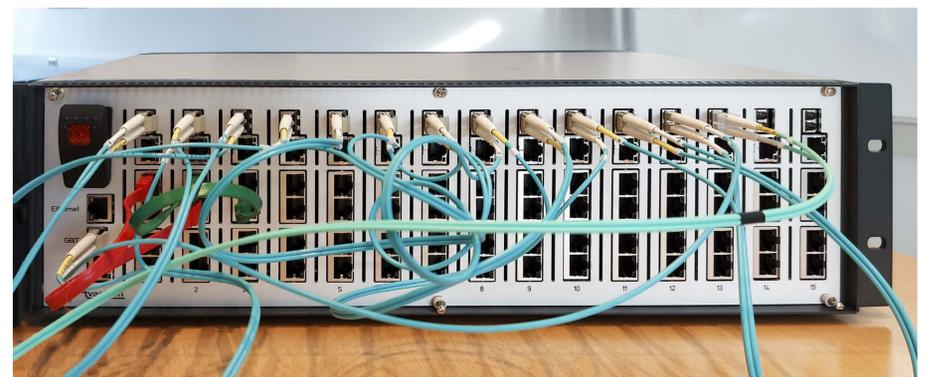
Ein Rack mit 15 unabhängigen Recheneinheiten.
